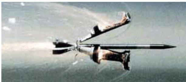
Nach dem Abschuß fallen die Teile der Führungshalterung ab und das pfeilförmige Urangeschoß fliegt mit hoher Geschwindigkeit ins Ziel.
